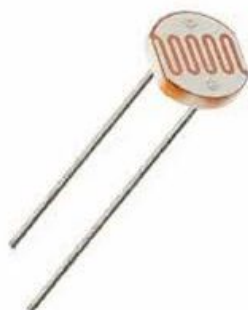
kil 3. Fotorezistor (LDR)
